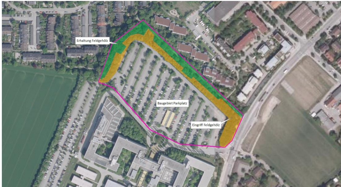
Abbildung 2: Übersicht über die Eingriffsbereiche. Der Eingriff in das Feldgehölz ist orange, die Erhaltungsflächen sind grün eingefärbt, © Steil 2020
